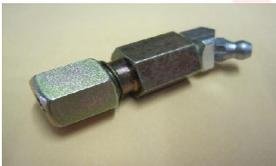
Schraubverschraubung mit Schmiernippel
