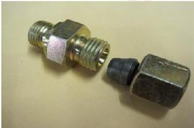
Einschraubgewinde 1/4" Rohranschluß 6S
