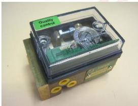
**Schrittschaltwerk - Bremszähler -**
