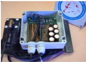
**Zeitsteuergerät für Fließfettanlage**
