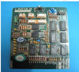
**Steuerplatine Lincoln elektrische Fließfettpumpe**
