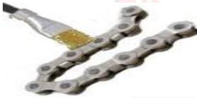
Oelaufstreichbürste für Kettenschmierung
