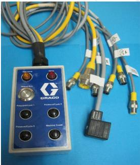
Funktionsprüfgerät Graco ( Max) Pumpe
