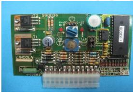
**Steuerplatine für Pumpen mit Endschalter**
