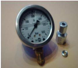
**Druckmanometer für Pumpenabgang 341000**
