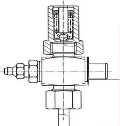
Überdruckventil 90c 300 Bar
